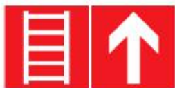
Пожарная лестница вверх
