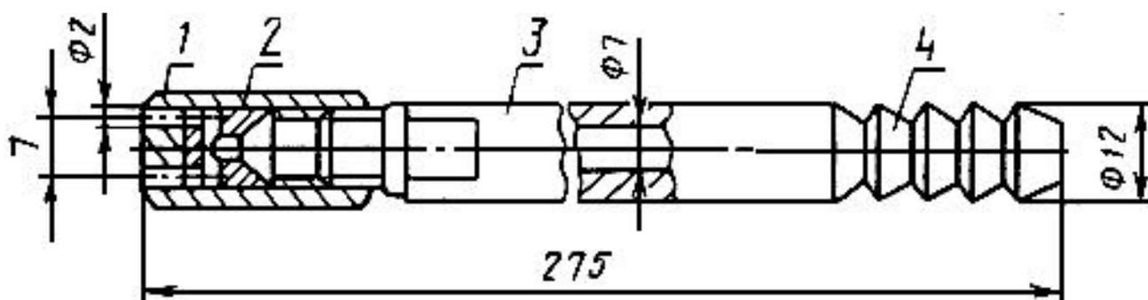
1 - насадок; 2 - распределитель; 3 - трубка; 4 - штуцер
