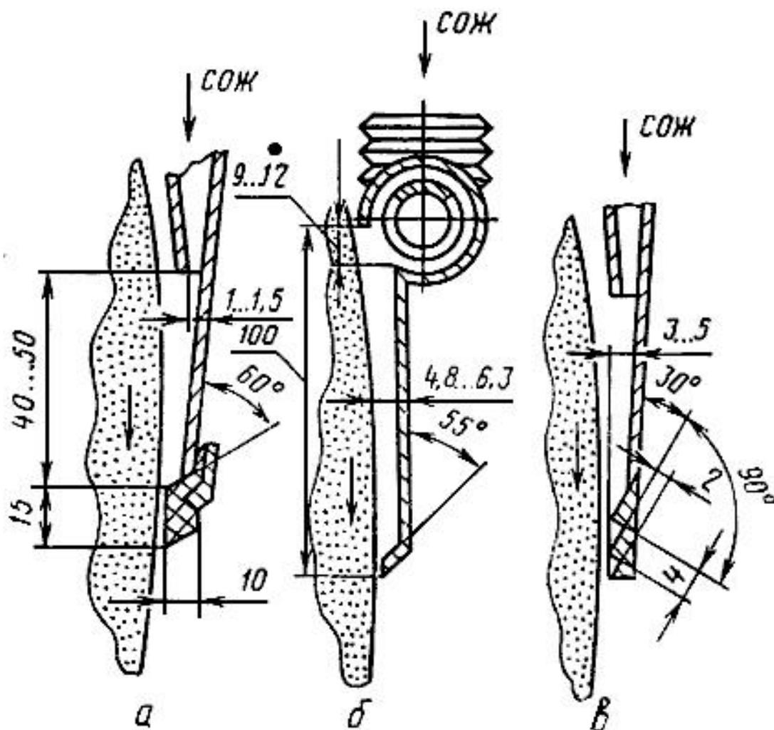
а - с поропластовой пластиной; б - с жестким козырьком; в - с жесткой зубчатой заслонкой
