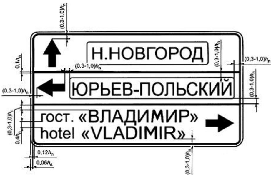
Рисунок Г.4 - Пример компоновки знака индивидуального проектирования 6.10.1
